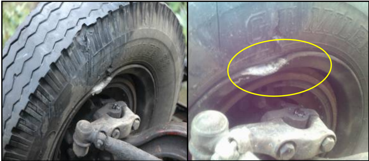
Gambar.2.3 Kondisi ban bagian depan sebelah kanan yang robek dan velg ban yang celok pada satu titik akibat benturan pada bahu jembatan.
