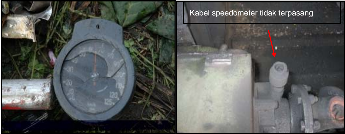
Gambar.2.7 Speedometer kendaraan bus ditemukan dalam keadaan sudah terlepas dari tempatnya dan soketnya, kacanya pecah dan pecahan kaca tersebut menahan jarum penunjuk kecepatan dengan posisi jarum menunjuk di angka " 65 Km/Jam". Sementara pada bagian lain ditemukan saluran kabel tali pengukur kecepatan tidak terhubung dengan speedometer-nya.
