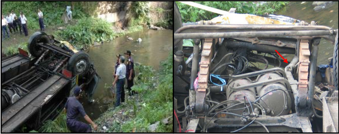
Gambar.2.1 Frame / rangka bus bagian depan bengkok, terutama bagian sebelah kanan depan
