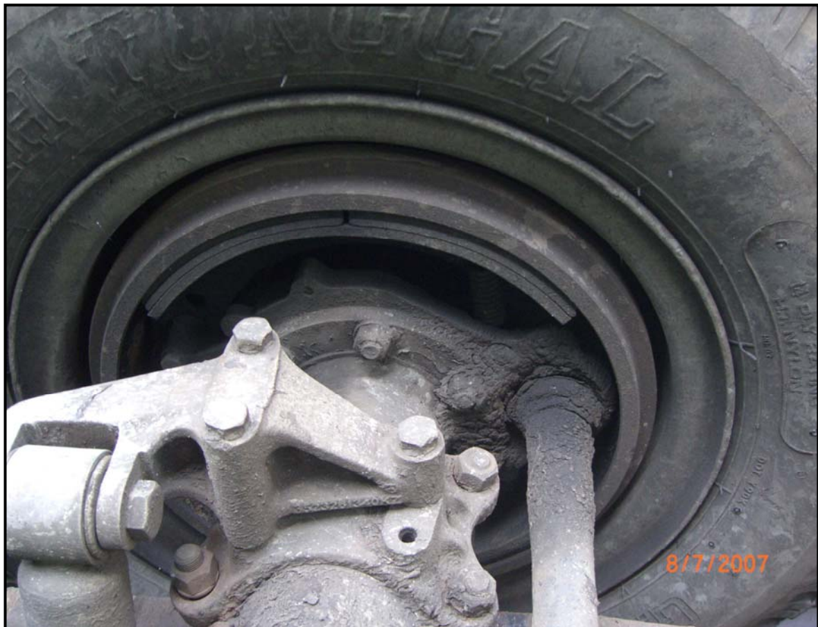
Gambar.2.4 Pada semua bagian roda-roda kendaraan bus cukup kering tidak ada bekas kebocoran minyak atau oli, juga terlihat kampas rem pada masing-masing roda masih cukup tebal. Semua ketebalan kampas rem ini dapat " langsung terlihat " karena pada semua bagian rem ini " tidak tertutup cover ". Tromol bagian dalam rem sudah mengalami " keausan antara satu sampai dua milimeter " baik pada masing – masing bagian roda depan dan belakang.
