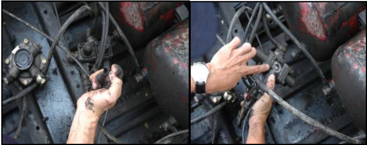
Gambar.2.5 Susunan sistem pengereman tersusun dengan dua tabung reservoir angin pada bagian depan untuk sistem rem bagian depan (tabung.1) dan satu tabung pada bagian belakang untuk sistem bagian rem belakang (tabung.2) yang terletak dibagian rangka depan. Selang regulator penghubungnya pecah, pipa pembagi tekanan angin juga patah, ini akibat dari benturan dengan palang rangka tengah. (cross member) di bagian rangka depan bus.
