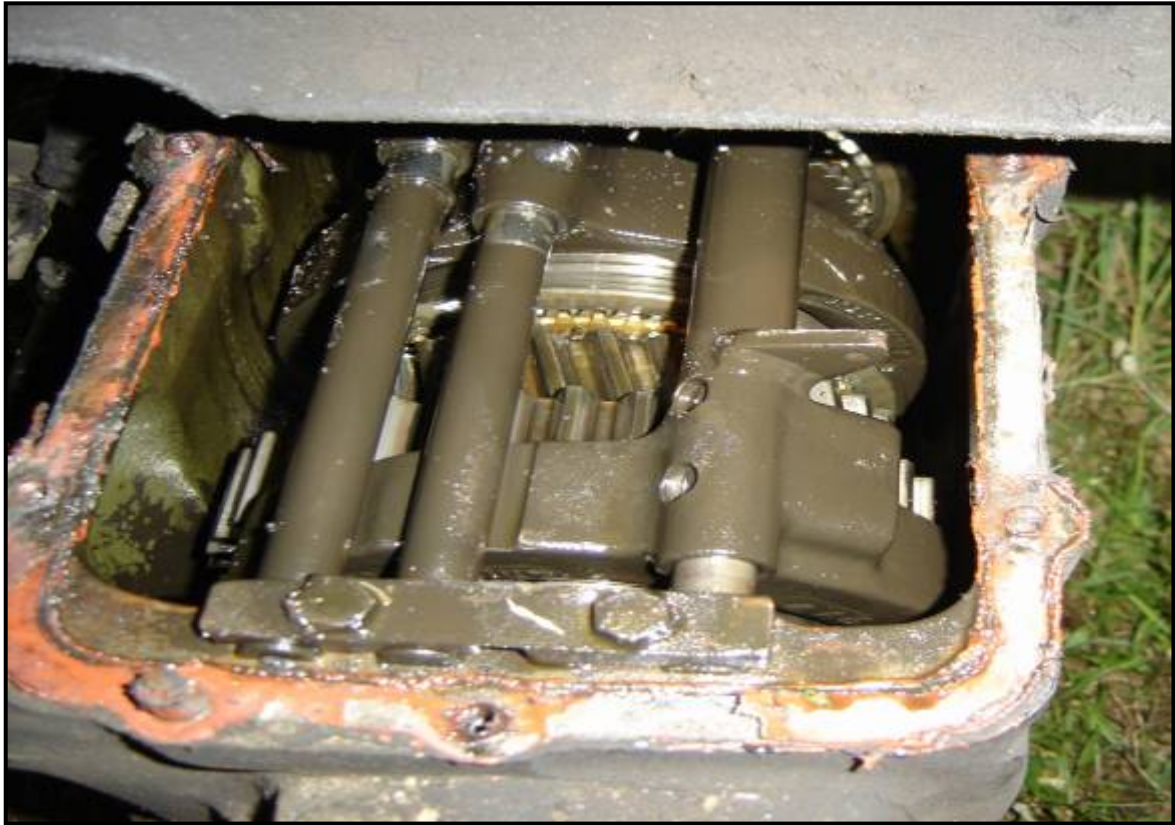
Gambar.2.9 setelah membuka penutup rumah pengatur pemindah gigi dibuka, transmisi bus berada dalam posisi NETRAL.
